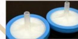
Para soluciones acuosas y HPLC. Filtración y esterilización de soluciones acuosas, especialmente en la industria farmacéutica, solventes para HPLC, alcoholes, bases y ésteres.
