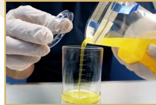
Unidades filtrantes estériles descartables, para control microbiológico mediante la técnica de filtración por membrana. Reducen hasta un 70% el tiempo en la realización de los análisis. Minimizan los riesgos de contaminación cruzada. Esterilizados por radiación gamma.
